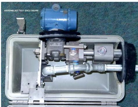
Опыты проведены в камере кондиционирования воздуха для концепта против замерзания и пригодны в климатических условиях от  $T \geq -47^{\circ}\text{C}$  с дополнительным воздействием ветра для проекта в Северной Канаде
